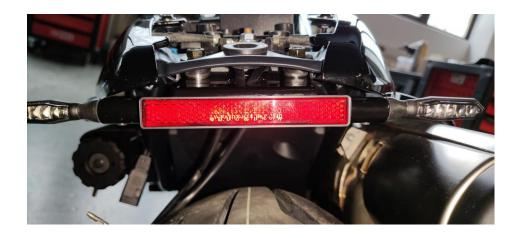
3. Danach können die Befestigungsschrauben (Linsenkopfschraube M6x20) angezogen werden.
